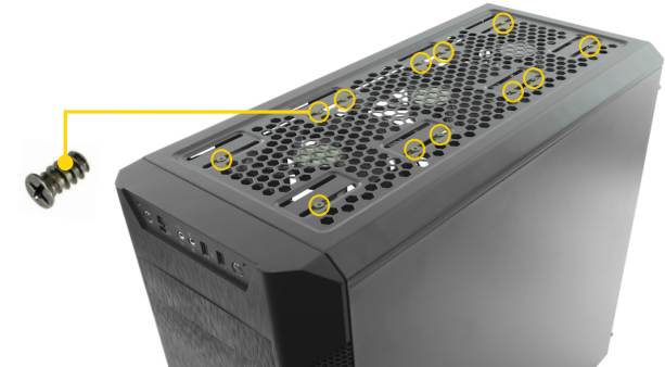
EN: Install the 120 mm fans using dedicated screws PL: Przykręć wentylatory 120 mm używając dedykowanych śrubek
